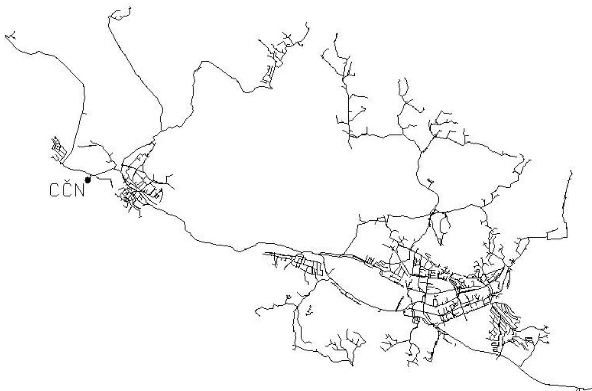
Slika 9: Shema kanalizacijskega sistema Velenje-Šoštanj
