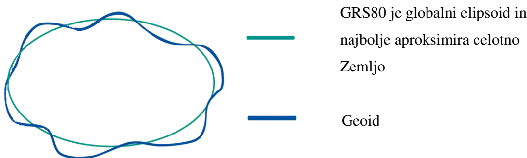
Slika 1: Prileganje elipsoida GRS80 celotni Zemlji
