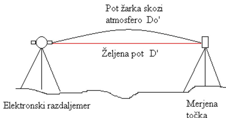
Slika 24: Pot merskega žarka skozi atmosfero
