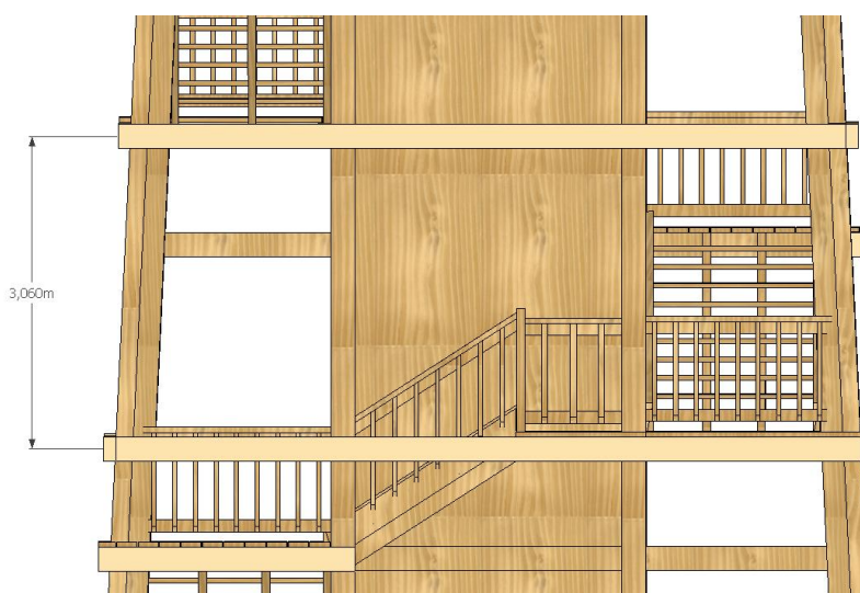
Slika 23: Tipičen odsek konstrukcije za račun vpliva vetra na obodni del
