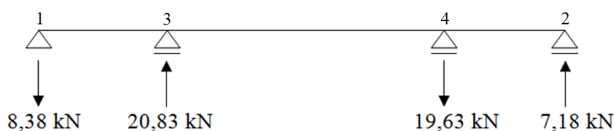
Slika 96: Reakcije/notranje sile v veznih el. zaradi globalne obtežbe vetra v smeri X
