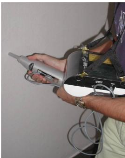
Slika 4: Nedestruktivna preiskava; ugotavljanje površinske tlačne trdnosti betona (Dolinšek, 2010: str. 7)
