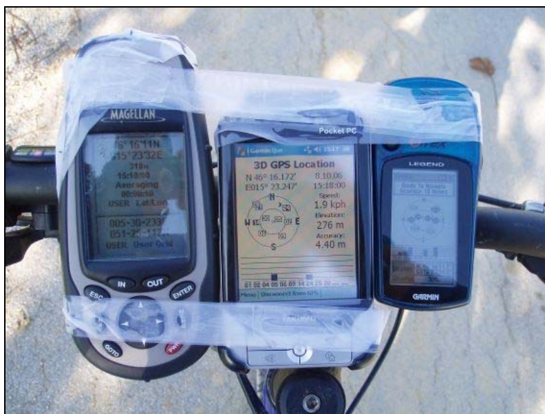
Slika 13: Testni sprejemniki, pritrjeni na krmilo kolesa
