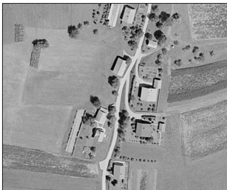
Slika 29: Vzorec Digitalnega ortofota merila v črno beli tehniki z velikostjo piksla 0,5 m
