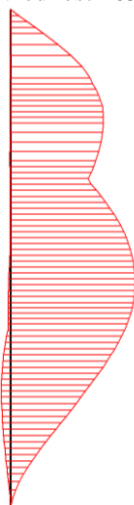
Ovojnica upogibnih momentov Ekstremna vrednost 491,95 kN/m/m
