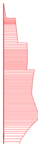
Ovojnica osnih sil Ekstremna vrednost -410,06 kN/m
