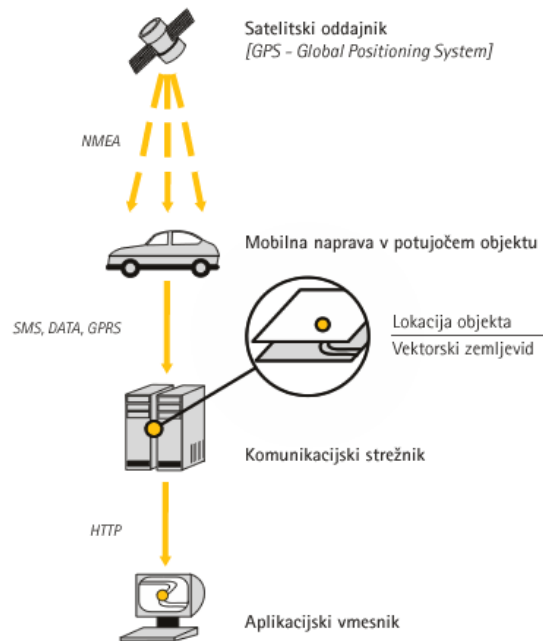
Slika 28: Delovanje sistema sledenja vozila
