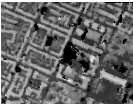
DMP 3: matrika iskanja 15x3 piksli, tarča 7x7 pikslov, mejni korel. koef. 0.80, nizka stopnja glajenja, gričevnat tip reliefa
