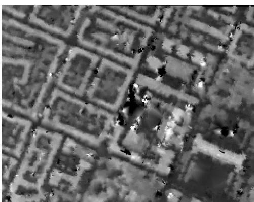
DMP 6: matrika iskanja 17x5 pikslov, tarča 7x7 pikslov, mejni korel. koef. 0.80, nizka stopnja glajenja, gričevnat tip reliefa
