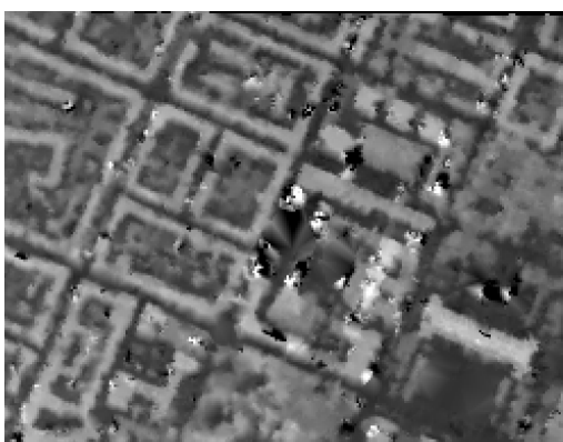
DMP 5: matrika iskanja 19x5 pikslov, tarča 7x7 pikslov, mejni korel. koef. 0.80, nizka stopnja glajenja, gričevnat tip reliefa
