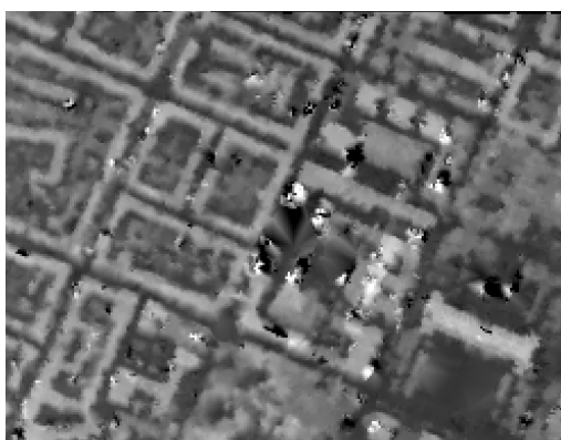
DMP 11: matrika iskanja 19x5 pikslov, tarča 5x5 pikslov, mejni korel. koef. 0.80, nizka stopnja glajenja, gričevnat tip reliefa
