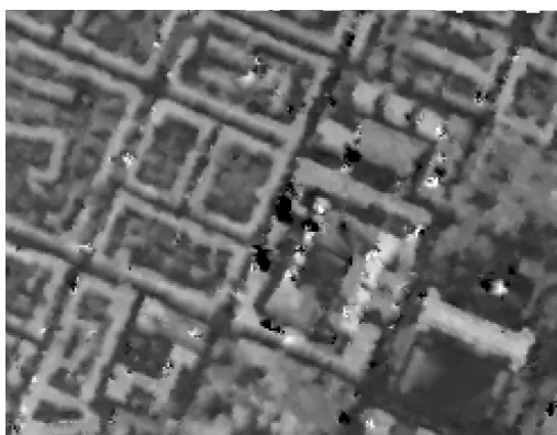
DMP 9: matrika iskanja 19x5 pikslov, tarča 9x9 pikslov, mejni korel. koef. 0.80, nizka stopnja glajenja, gričevnat tip reliefa
