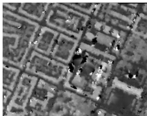
DMP 8: matrika iskanja 21x5 pikslov, tarča 7x7 pikslov, mejni korel. koef. 0.80, nizka stopnja glajenja, gričevnat tip reliefa
