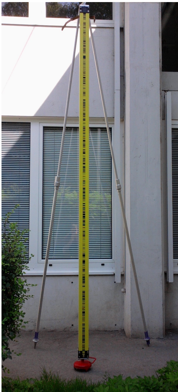
a) postavljena kodirana invar nivelmanska lata
