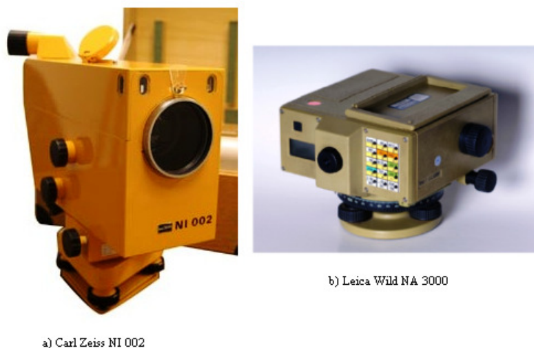
Slika 10: Uporabljena precizna nivelirja
