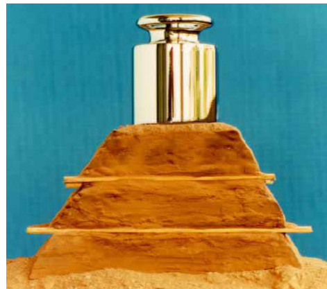
Slika 4: Zemljina z ojačitvijo.
