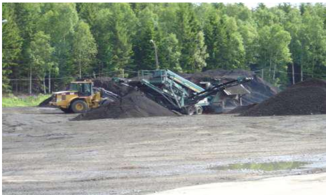
Slika 1: Dozorel, stabiliziran, zdrobljen in presejan odpadni lesni pepel v kupih (Ribbing, 2010)
