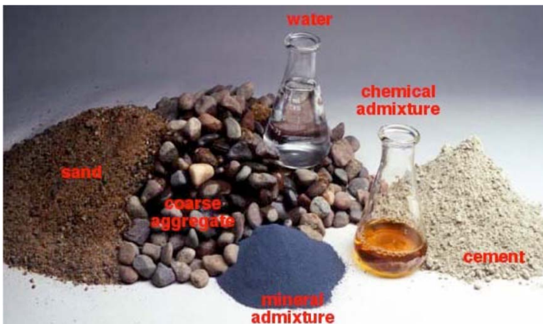
Slika 11: Osnovne sestavine betona.
