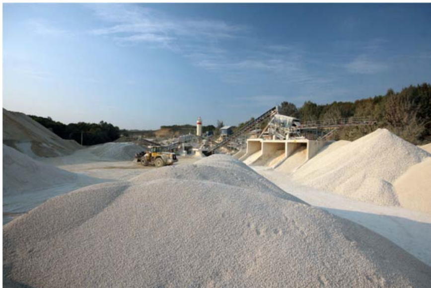
Slika 15: Drobljenje in sortiranje drobljenega agregata po različnih frakcijah.
