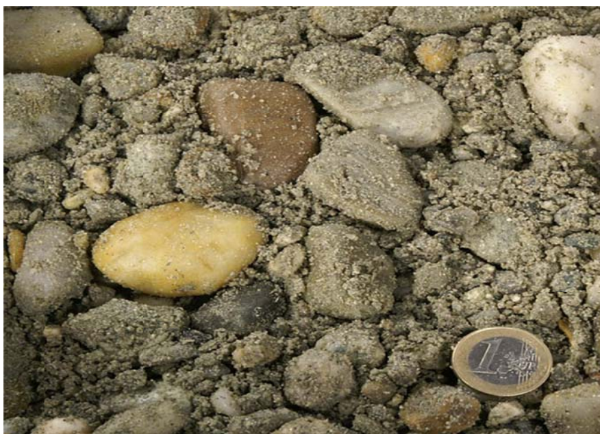
Slika 16: Sejani gramoz kot agregat za beton.
