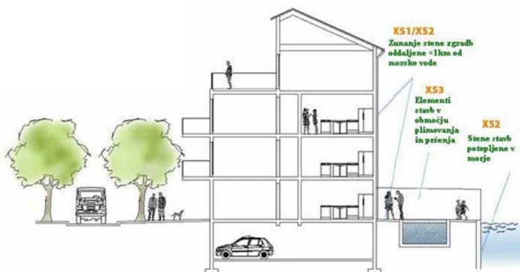
Slika 29: Vpliv korozije zaradi kloridov iz morske vode Vir: www.jadranka.si
