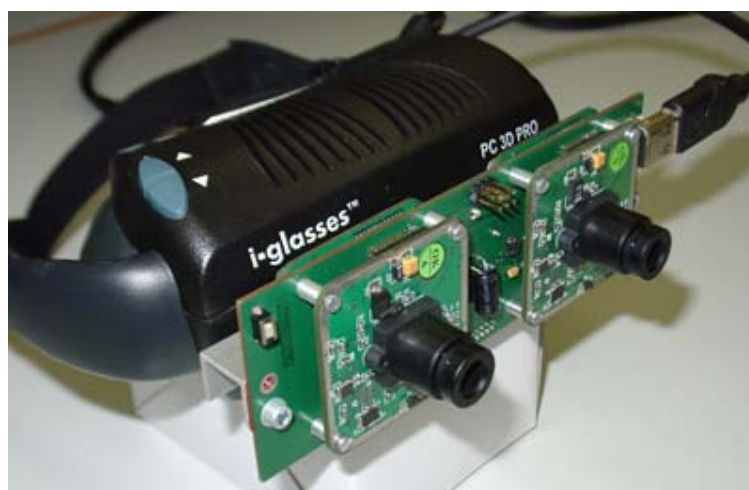
Slika 17: Prikaz zgradbe stereoskopskih očal
