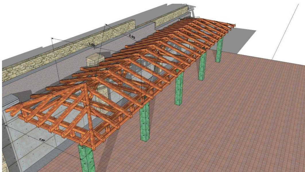
Slika 32: Osnutek lesenega nadstreška
