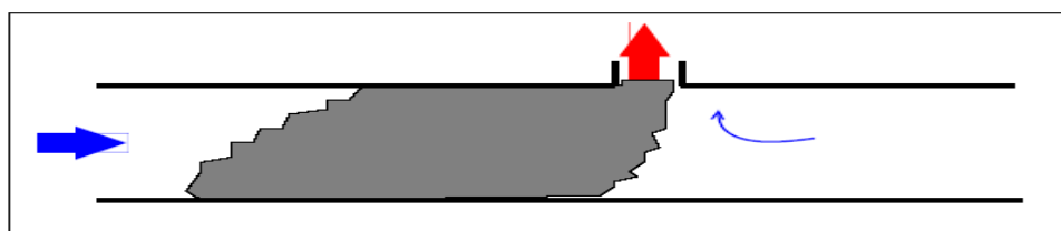
vzdolžno prezračevanje in izpust skozi vertikalni jašek
