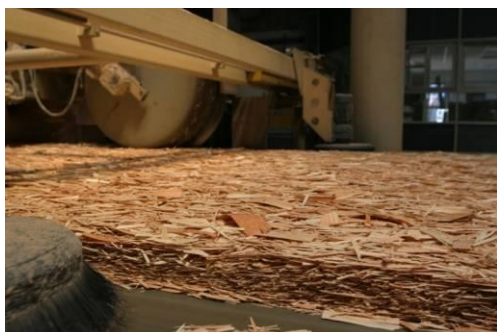
Slika 2.14: OSB plošča pred stiskanjem
