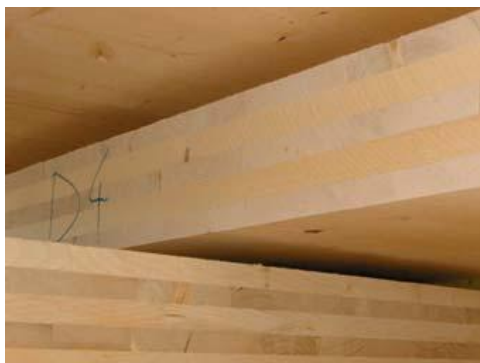
Slika 2.27: 5 slojne križno lepljene lesene plošče
