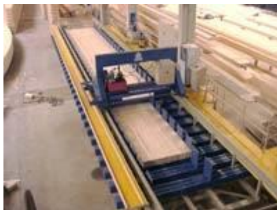
Slika 2.24: Naprava za stiskanje DUO in TRIO nosilcev ( www.ledinek.com )
