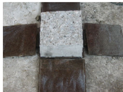
Slika 5.10: Podlaga za sanacijski beton nameščena v kalup.
