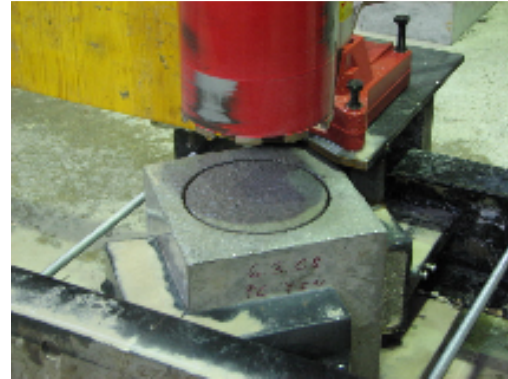
Slika 5.12: Preskušavec pripravljen za namestitev čepa.
