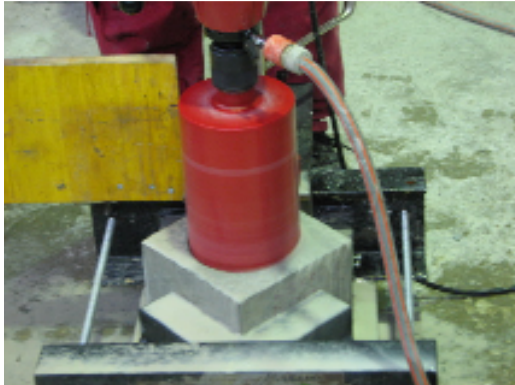
Slika 5.11: Vrtanje s krono premera 150 mm v kompozitni preskušavec.
