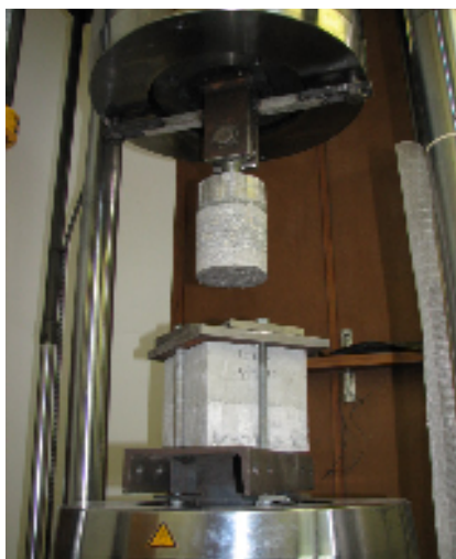
Slika 5.13: Preskušavec, vstavljen v stroj, po obremenitvi.
