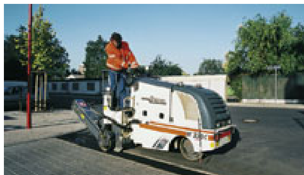
Slika 2.3: Primer opreme za rezkanje betona.
