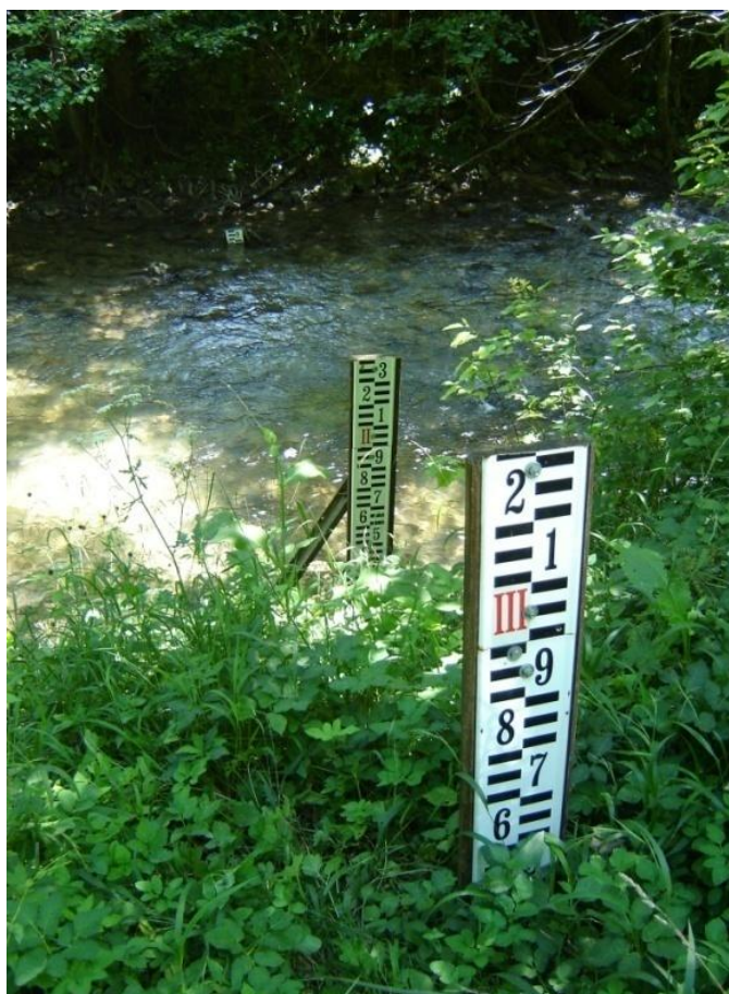
Slika 19: Vodomerna postaja Zagaj I, opremljena z vodomernimi letvami
