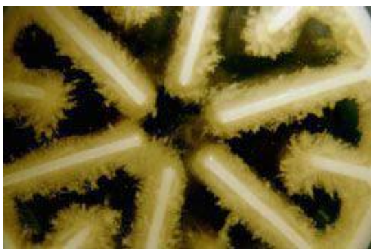
Slika 21: Biofilm priraščen na nosilec ( http://www.anoxkaldnes.com )
