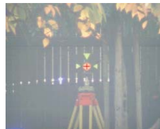
Slika 35: Prikaz testnega polja 2 – park (širokokotni pogled) in treh prizem (podoba, zajeta s pomočjo senzorcija v daljnogledu instrumenta).
