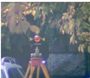
Slika 35: Prikaz testnega polja 2 – park (širokokotni pogled) in treh prizem (podoba, zajeta s pomočjo senzorcija v daljnogledu instrumenta).
