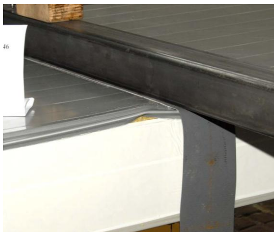
Slika 72: Gubanje1 panela FTV 200 na preizkusu
