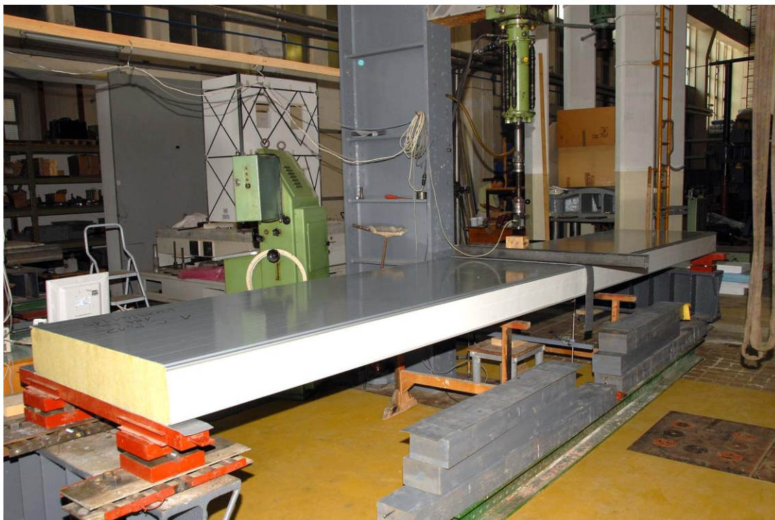
Slika 4: Eksperimentalni preizkus panela FTV 200 pri gubanju na srednji podpori
