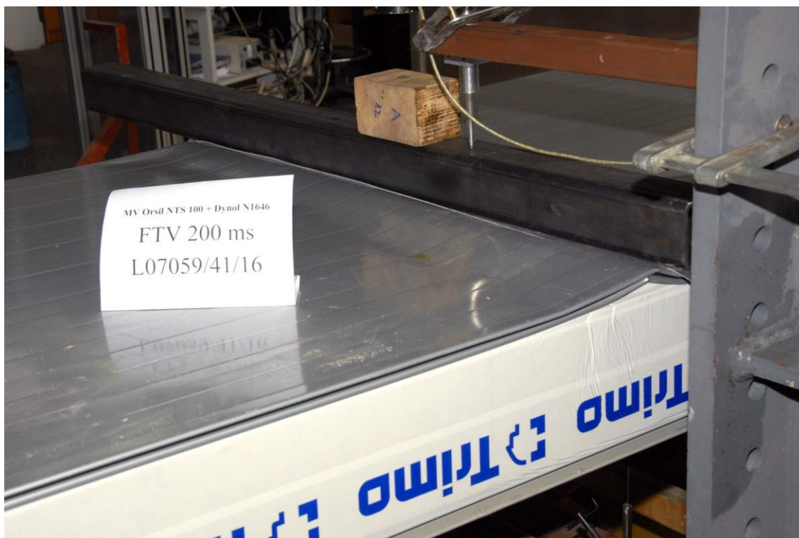
Slika 5: Gubanje panela FTV 200 na srednji podpori
