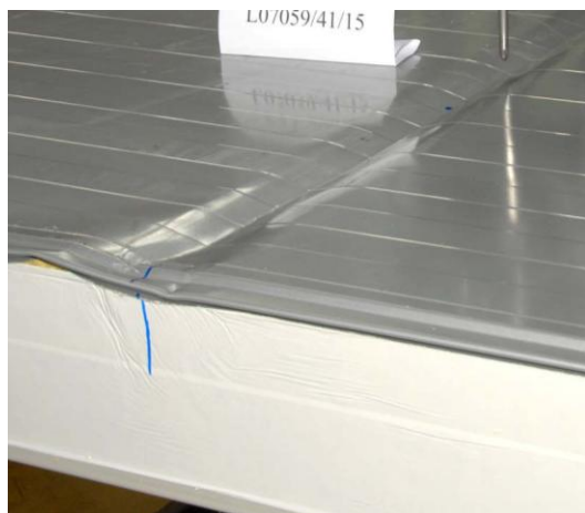
Slika 73: Gubanje2 panela FTV 200 na preizkusu
