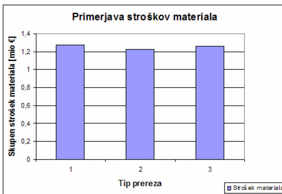
Slika 7.35 Primerjava stroškov za porabljeni material vseh treh tipov prerezov.
