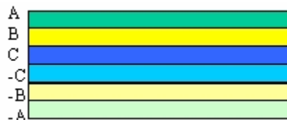
Slika 3.4 Antisimetričen balansiran laminat [A,B,C,-C,-B,-A] .
