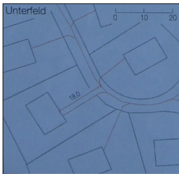
Slika 9: Oddaljenost od glavnega voda v naselju Unterfeld.
