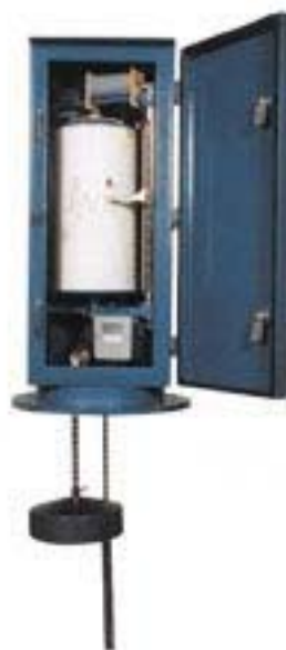
Slika 26: Notranjost limnigrafa z pisalom in valjem, na katerem je papir.
