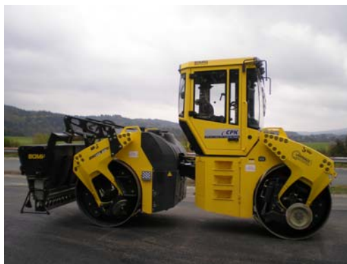
Slika 47: Dvokolesni vibracijski valjar s posipalnikom za valjanje DBM.
