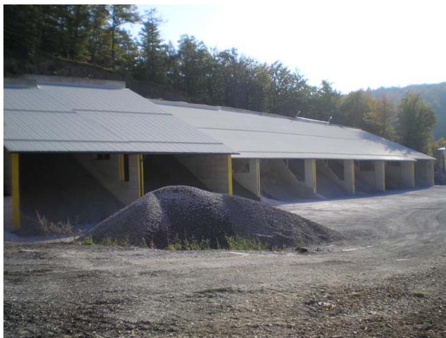
Slika 5: Skladiščenje frakcij kamnitih agregatov na AB Senožeče, podjetja CPK, d. d.
