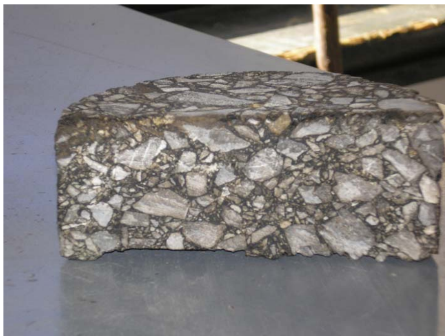
Slika 9: Sestava bituminiziranega drobljenca BD 22, prikazana v prerezanem vzorcu vrtine.
