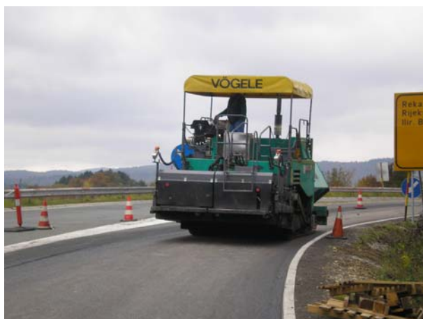
Slika 45: Finišer na podvozju z gosenicami.
