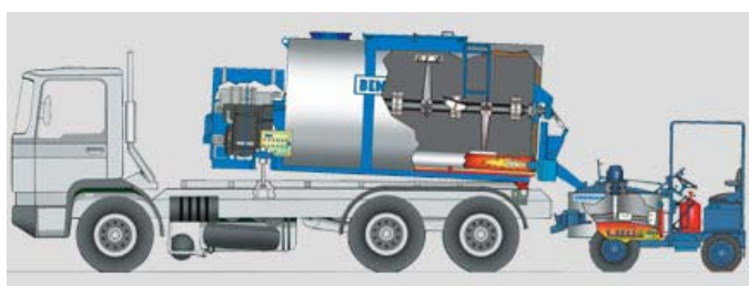
Slika 14: Prikaz mešanja in izpusta litega asfalta iz kotla v prekucnik.
