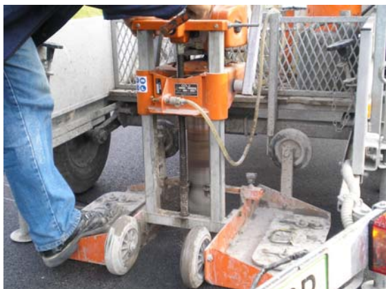
Slika 48, 49: Naprava za vrtanje in vzorec oz. jedro vrtine.
