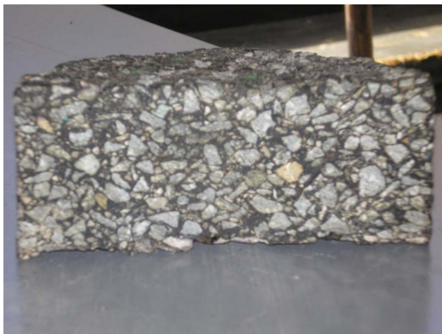
Slika 10: Sestava DBM 8s, prikazana v prerezanem vzorcu vrtine.
