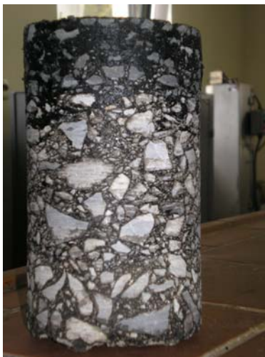
Slika 6: Vrtina za preiskavo v laboratoriju, nosilna plast (BD 22S) in obrabna plast (DBM 11s).
