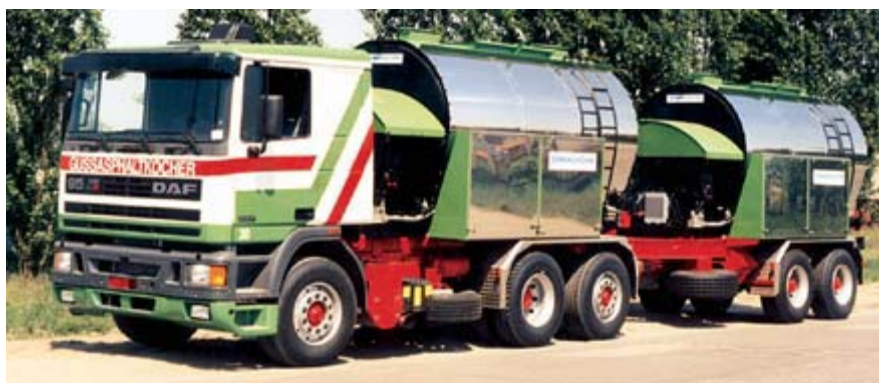
Slika 13: Transportna kotla za prevoz litega asfalta.
