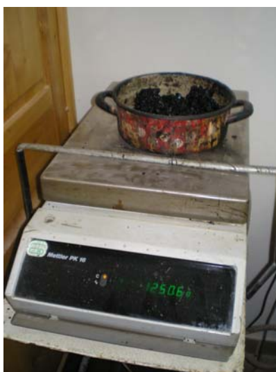
Slika 16: Tehtanje asfaltne zmesi po končanem mešanju.
