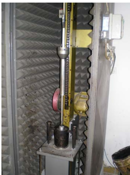
Slika 17: Nabijalo za pripravo preizkušancev po Marshallu.
