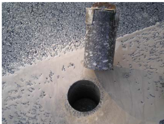
Slika 48, 49: Naprava za vrtanje in vzorec oz. jedro vrtine.
