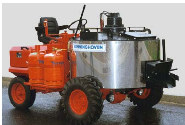
Slika 15: Prekucnik za transport in finišer za vgradnjo litega asfalta.
