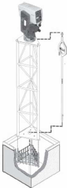
Slika 5: Stabilizacija z uporabo prenosljivih kovinskih stebrov (Vodopivec, Kogoj, 2005)
