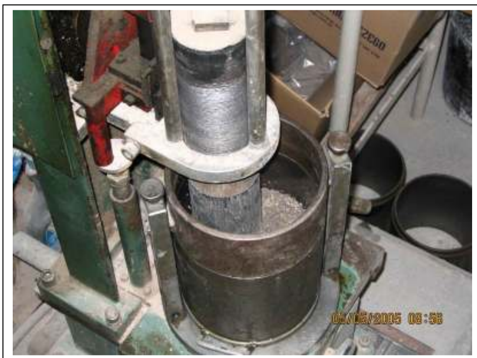
Slika 17: Postopek zgoščevanja zmesi zrn v jeklenem valju (kalupu) z nabijalom (po Proctorju)
