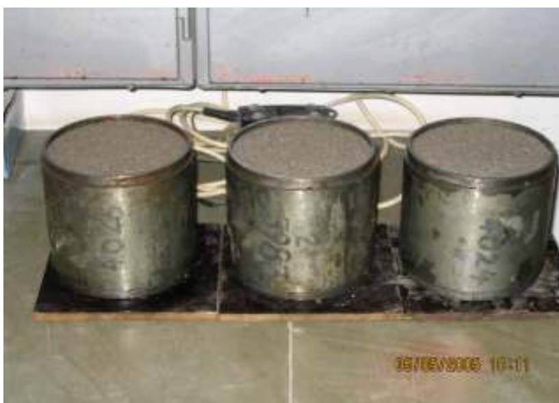
Slika 22: Preskušanci za določanje tlačnih trdnosti mešanice
