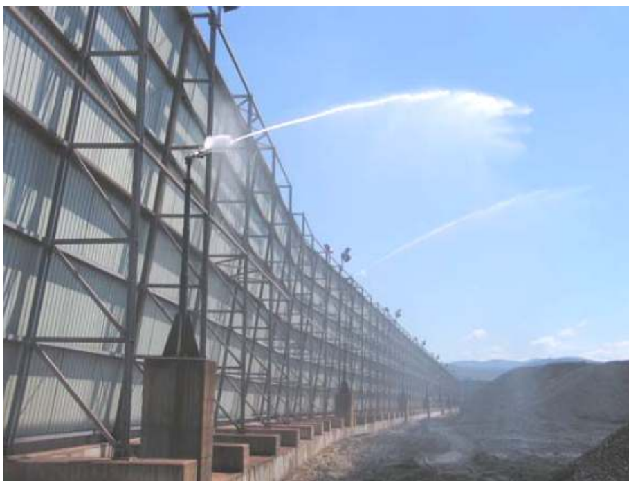
Slika 9: Protiprašna stena in vodne prhe (Ponting, 2007)
