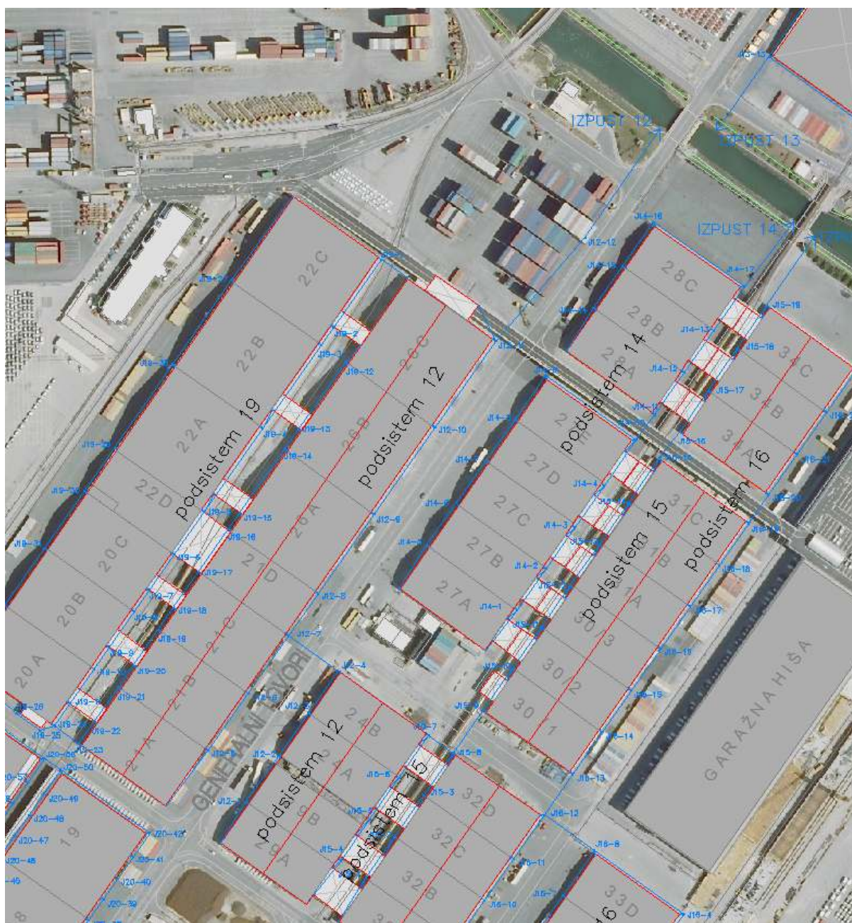
Slika 24: Podсистема 12 in 14 odvodnjavanja čiste meteorne vode- od jaška J12-1 do J12-12 in od jaška J14-1 do J14-17
