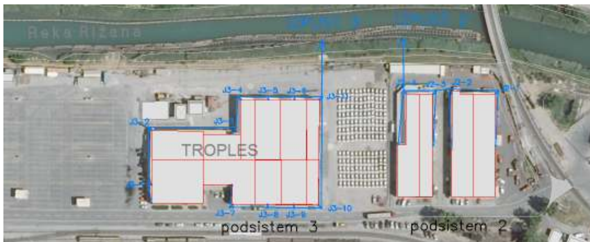
Slika 18: Podsistema 2 in 3 čiste meteorne vode - od jaška J2-1 do J2-4 in od jaška J3-1 do J3-11
