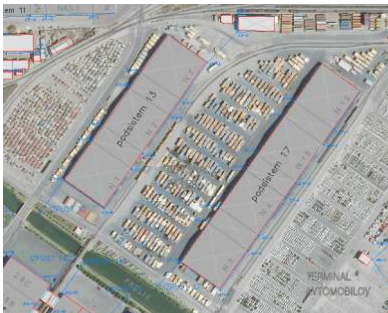
Slika 25: Podсистема 13 in 17 odvodnjavanja čiste meteorne vode - od jaška J13-1 do J13-13 in od jaška J7-1 do J17-14
