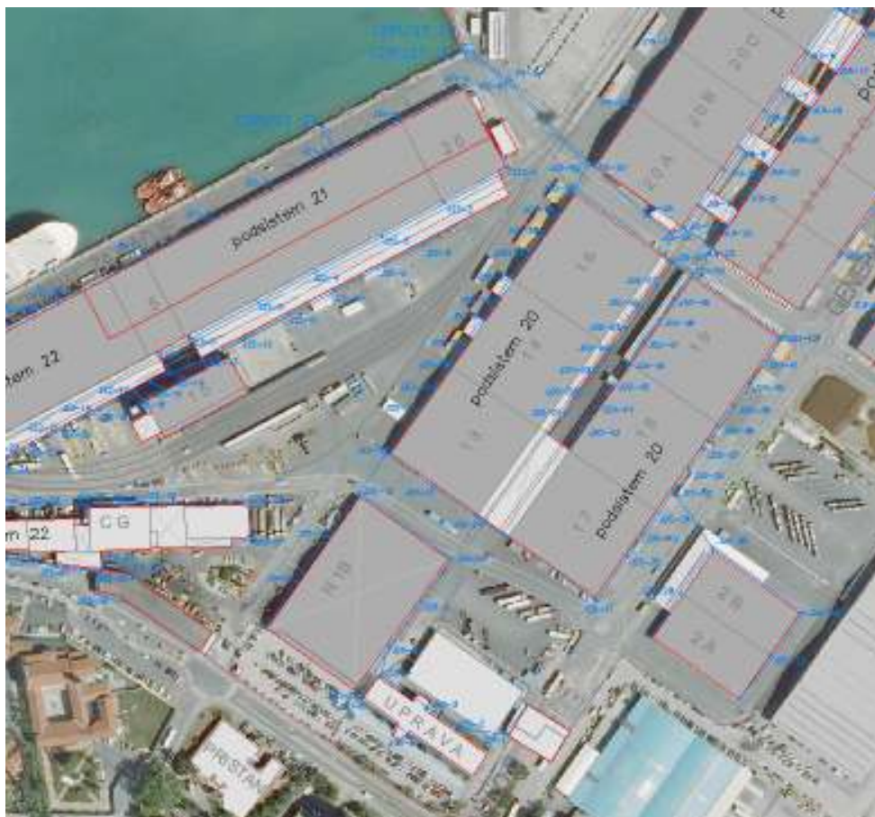
Slika 29: Podсистема 20 in 21 odvodnjavanja čiste meteorne vode - od jaška J20-1 do J20-61 in od jaška J12-1 do J21-6
