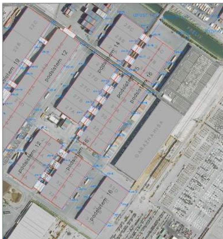
Slika 26: Podсистема 15 in 16 odvodnjavanja čiste meteorne vode - od jaška J15-1 do J15-19 in od jaška J16-1 do J16-23
