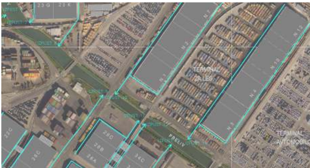
Slika 14: Odvodnjavanje čiste meteorne vode s strešin
