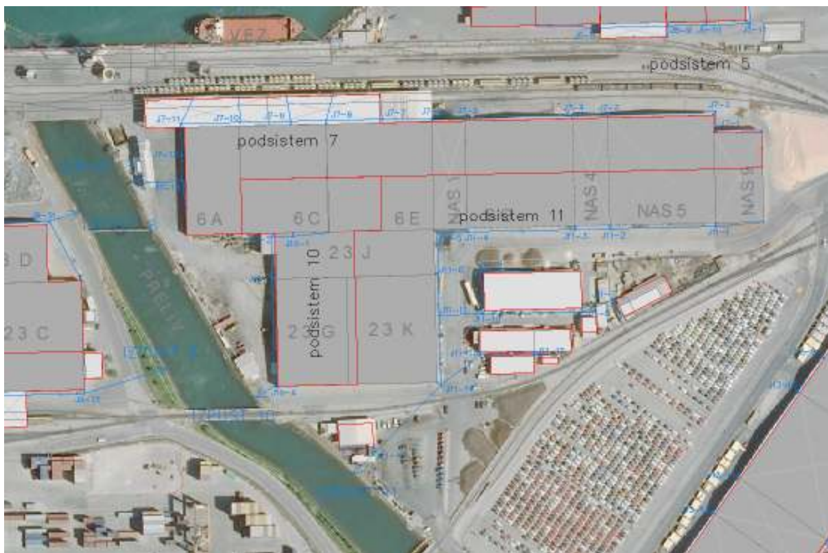
Slika 22: Podsystemi 7, 10 in 11 odvodnjavanja čiste meteorne vode - od jaška J7-1 do J7-13, od jaška J10-1 do J10-4 in od jaška J11-1 do J11-15
