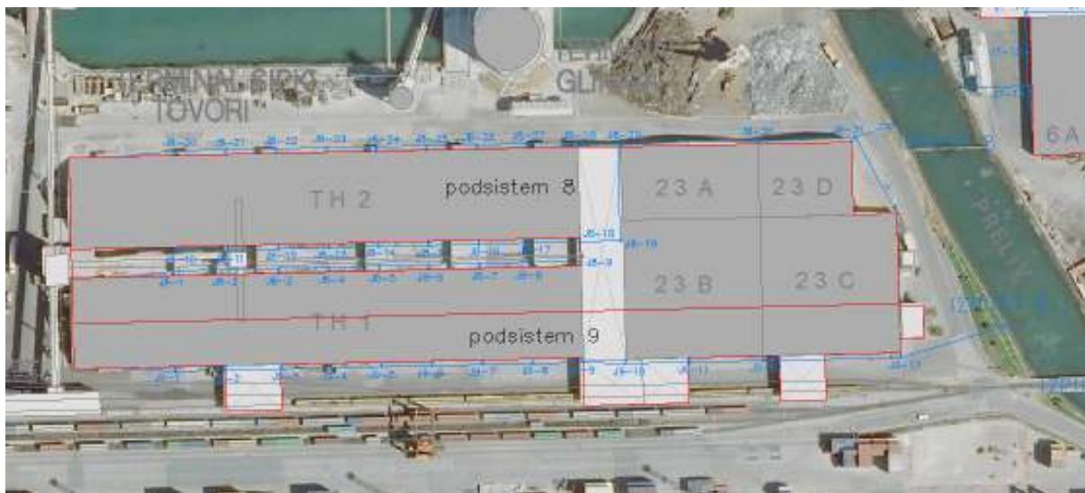
Slika 23: Podsystema 8 in 9 odvodnjavanja čiste meteorne vode - od jaška J8-1 do J8-31 in od jaška J9-1 do J9-13
