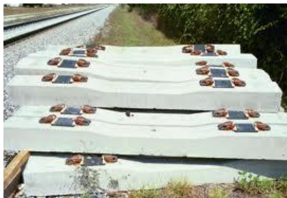
Slika 16: Enodelni betonski prag
