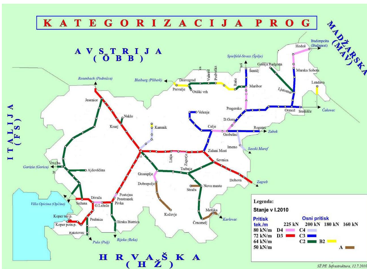
Slika 45: Grafičen prikaz glavnih in regionalnih prog glede na dovoljeno osno in dolžinsko obremenitev
