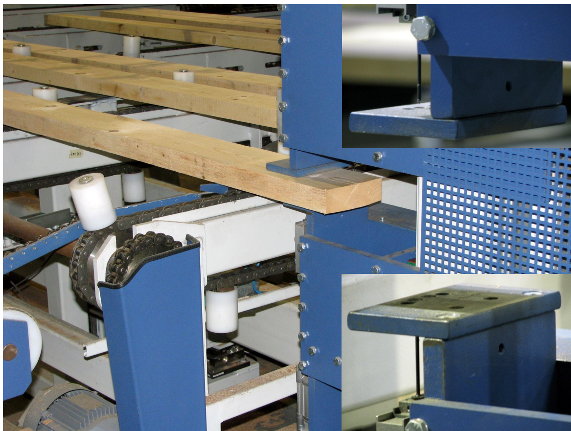
Slika 2.25: Meritev vlažnosti z napravo Triomatic, Gent, Belgija
