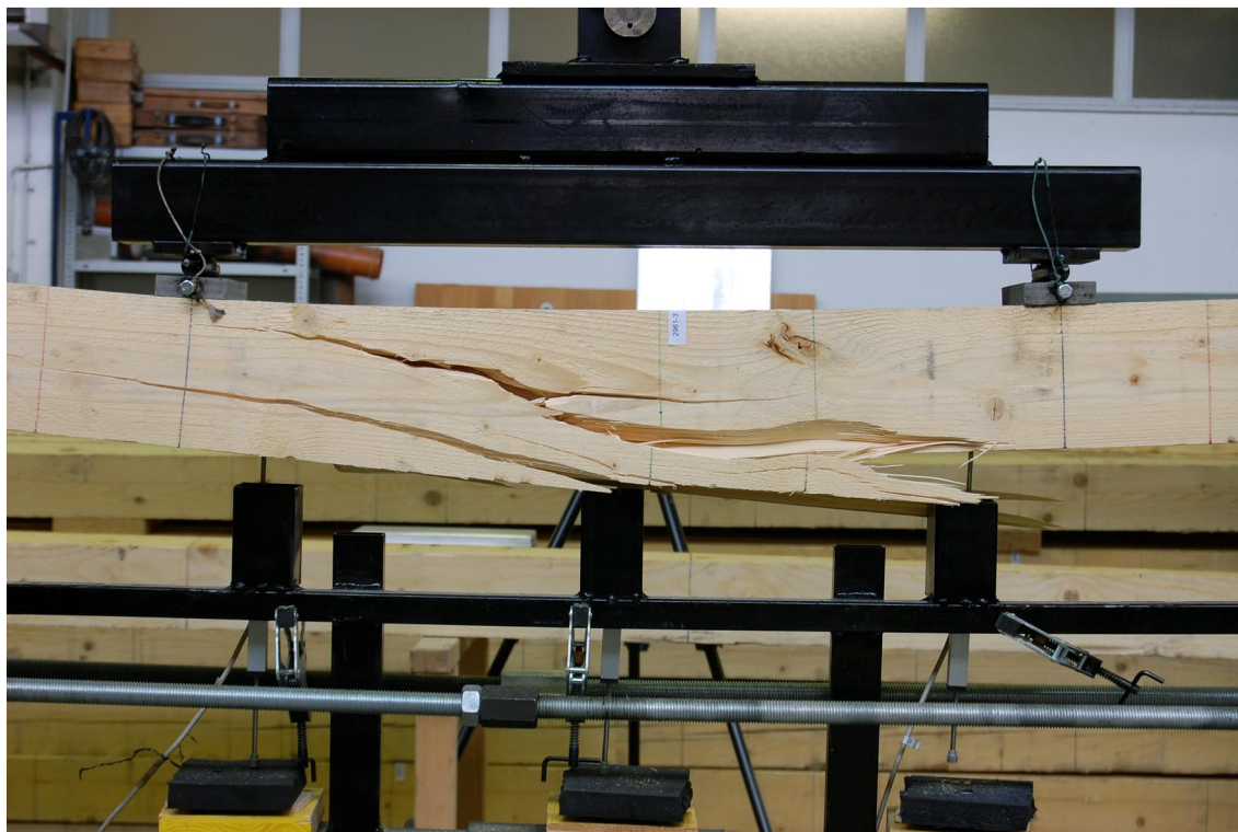
Slika 3.7: Primer porušitve (vzorec 2961 dimenzij 140 \times 140 mm)
