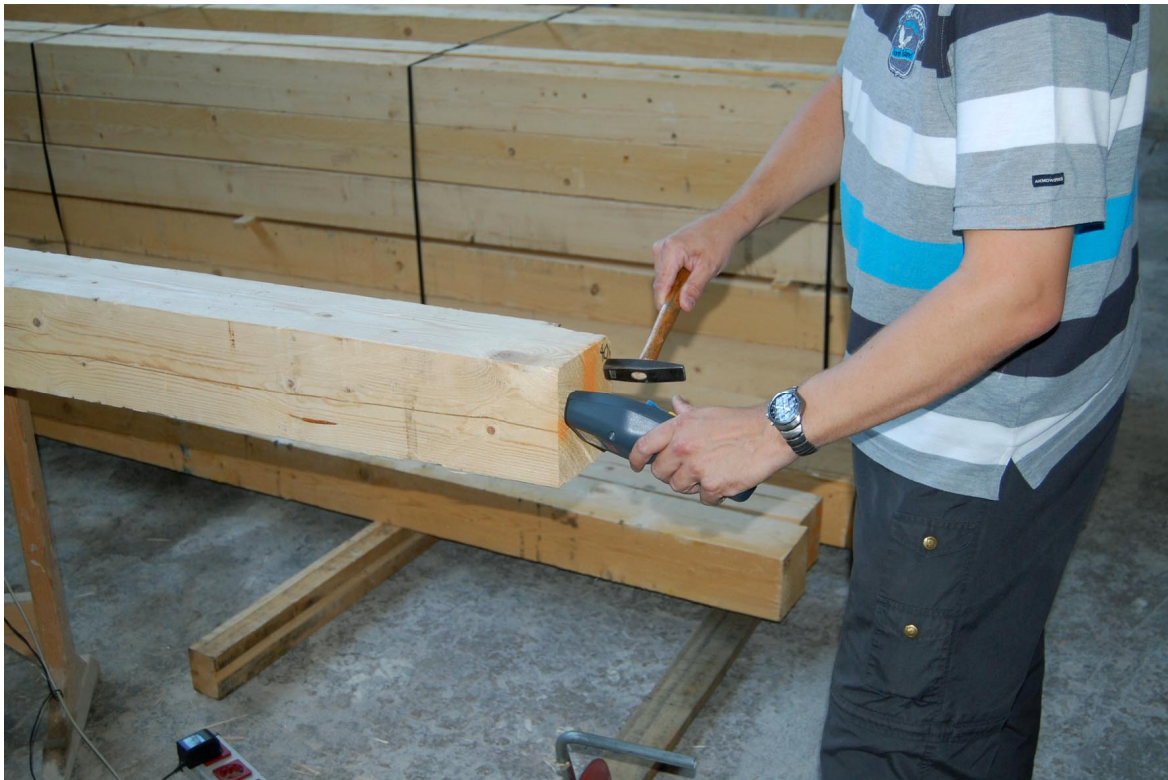
Slika 2.10: Meritev naprave Timber Grader MTG z uporabo ročnega kladiva (za večje kose)
