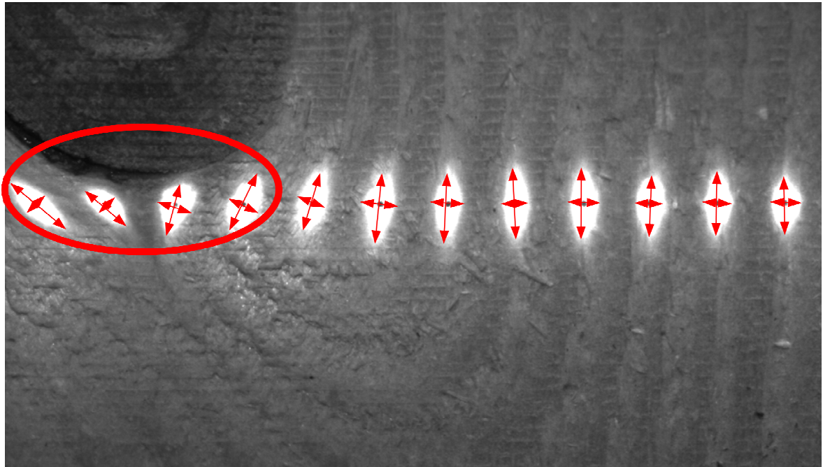
Slika 2.20: Prikaz laserske meritve smeri vlaken naprave CombiScan
