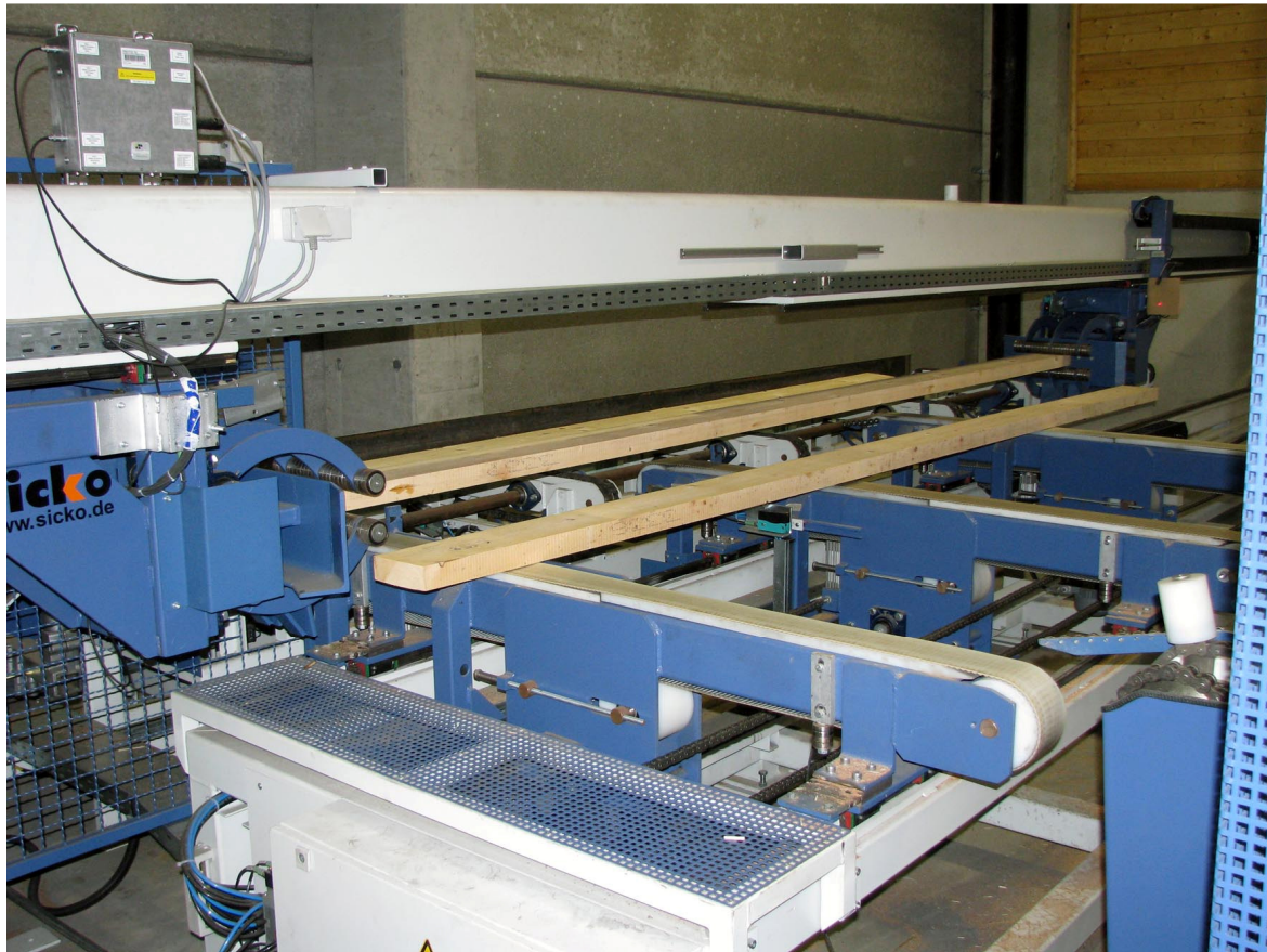
Slika 2.24: Meritev hitrosti ultrazvočnega preleta z napravo Triomatic, Gent, Belgija
