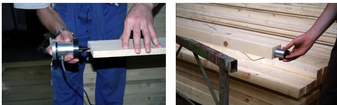
Slika 2.27: Merilni senzor naprave AU 2000 s koničnim nastavkom za les in brez njega
