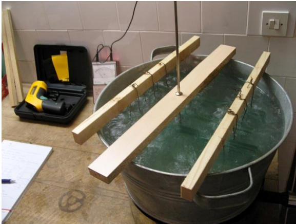
Slika 26: Vzorci med preskusom v vodi s temperaturo 99 °C
