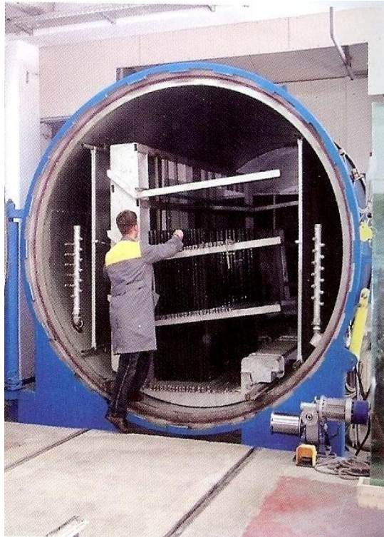
Slika 9: Lameliranje stekla v avtoklavu
