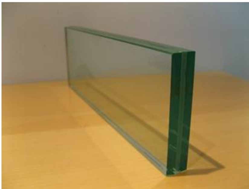
Slika 22: Preskusni vzorec lepljen iz dveh 10 mm stekel velikosti 300 x 100 mm
