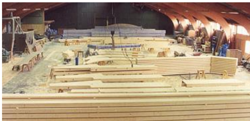
Slika 1: Proizvodnja lepljenih nosilcev Danskega podjetja Lilleheden ( http://www.lilleheden.dk/uk/glulam.asp , pridobljeno 30.12.2010)
