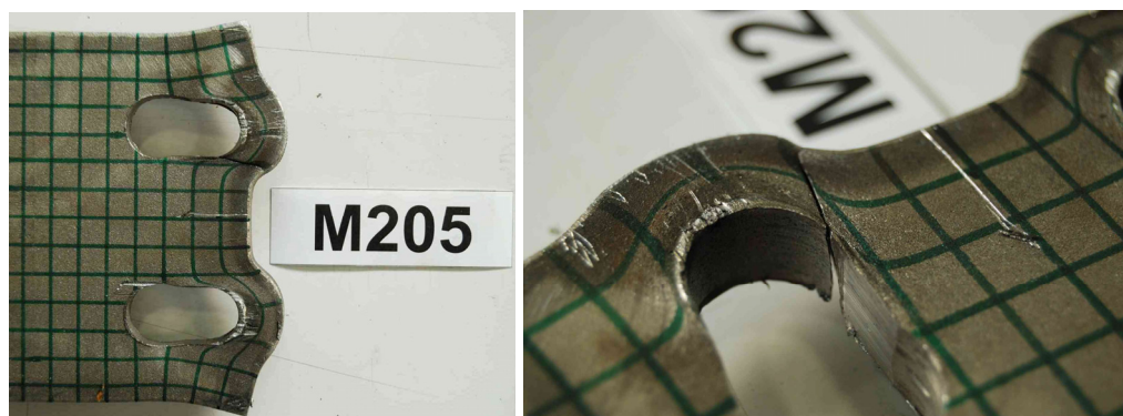
Slika 31: Deformiran vzorec M205. Strižni porušitvi se pojavita v območju pred vijakoma.
