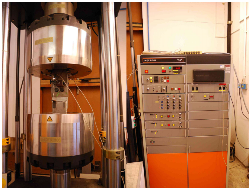
Slika 12: Instron preizkuševalna naprava na levi in kontrolni vmesnik na desni.
