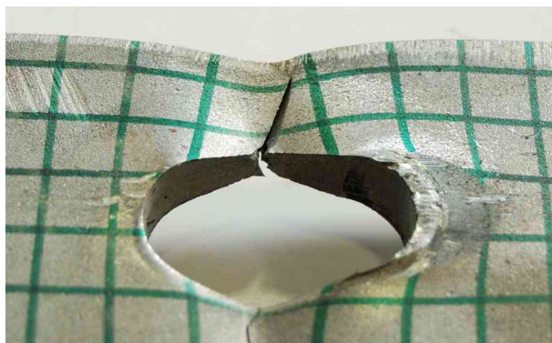
Slika 48: Na vzorcu spoja M206 je viden del prereza pred naleganjem vijaka, kjer pride do tlačnih napetosti v Z smeri in posledično do kontakta s trenjem.
