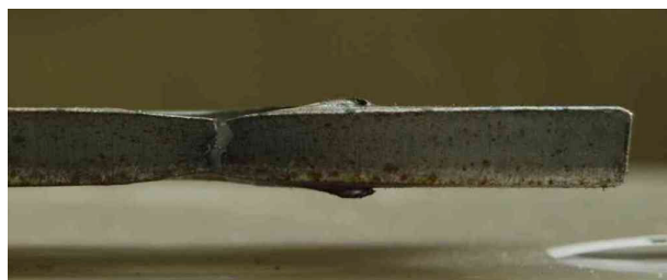
Slika 49: Na vzorcu spoja M204 je lepo viden del prereza pred naleganjem vijaka, kjer pride do razširitve prereza.
