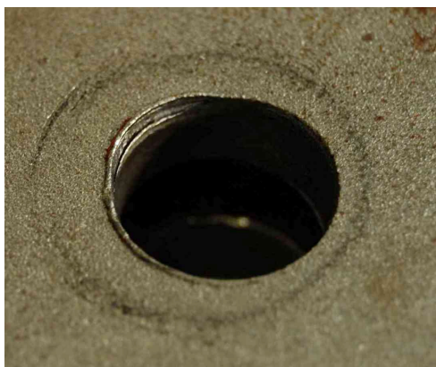
Slika 5: Deformacija vilic, ki jih obravnavam kot toge, v neposrednem naleganju vijaka za vilice M200a
