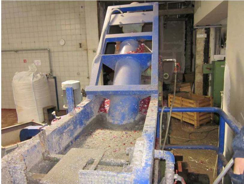
Slika 21: Polž, ki potiska drobce plastike v mlin
