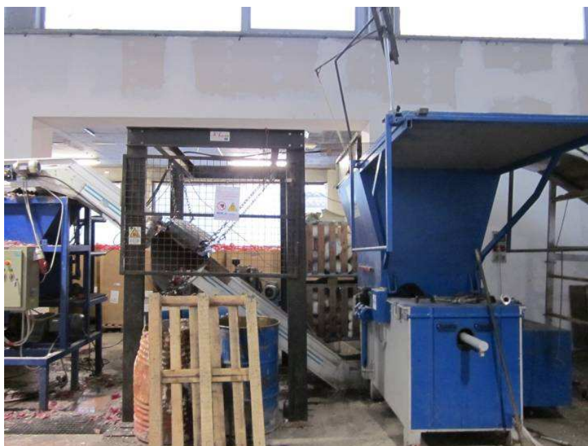
Slika 14: Trgalec in trak z magnetom za odstranjevanje taktov
