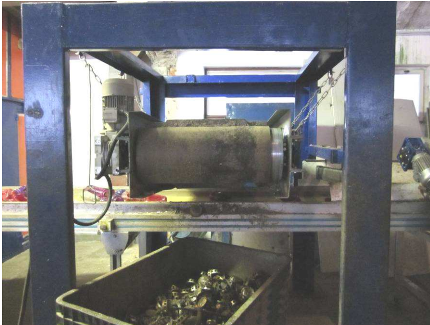
Slika 12: Magnet za odstranjevanje kovinskih pokrovčkov
