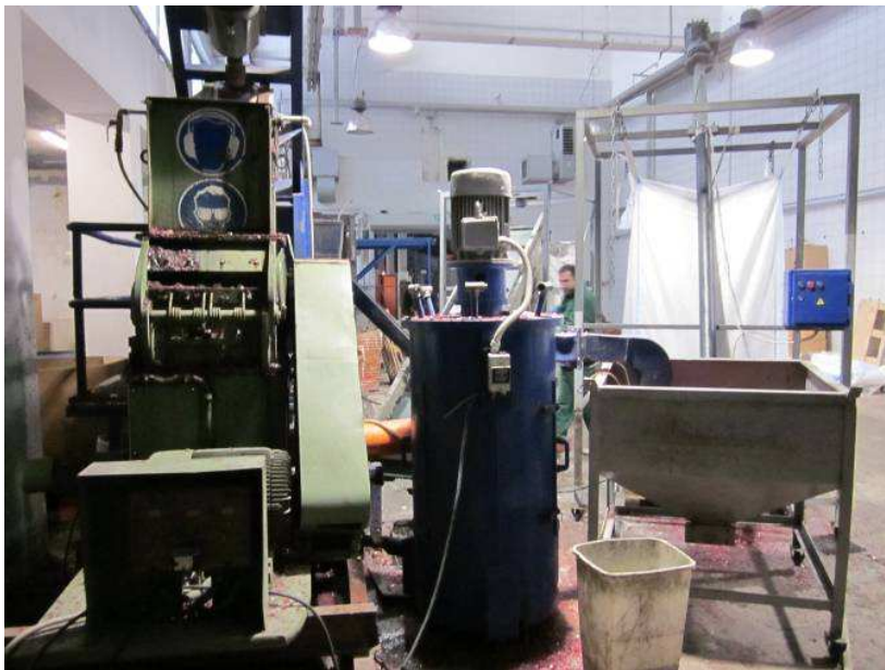
Slika 22: Mlin, pralna linija in centrifuga
