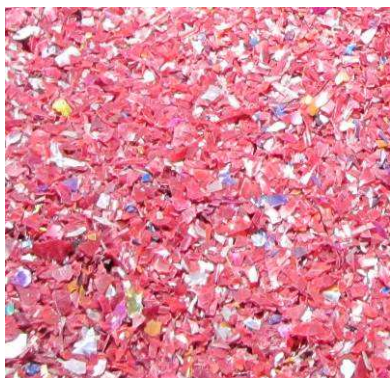
Slika 27: Produkt, ki nastane iz mletine odpadnih PVC sveč
