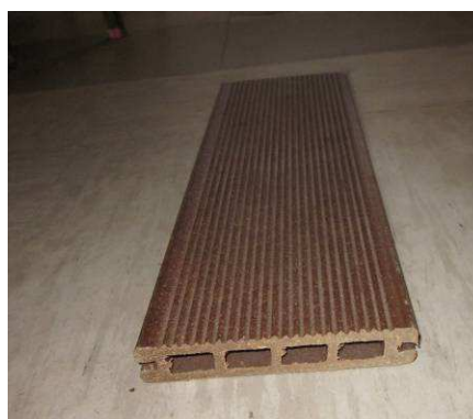
Slika 27: Produkt, ki nastane iz mletine odpadnih PVC sveč
