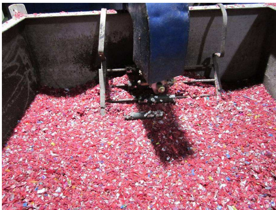
Slika 23: Mletina PVC ali ostale plastike – končni produkt predelave
