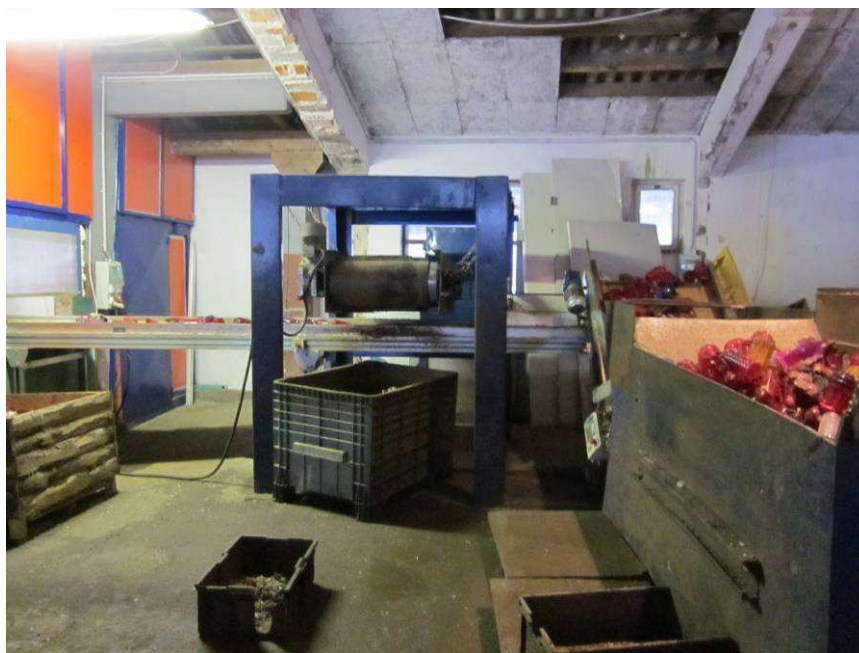
Slika 11: Začetna faza sortiranja – odstranjevanje pokrovčkov
