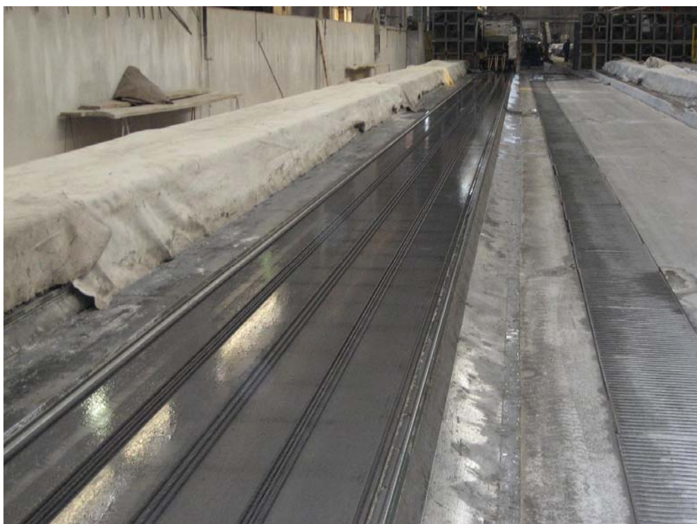
Slika 5: Pokrivanje plošč s paronepropustnimi membranami (filc, polivinil)
