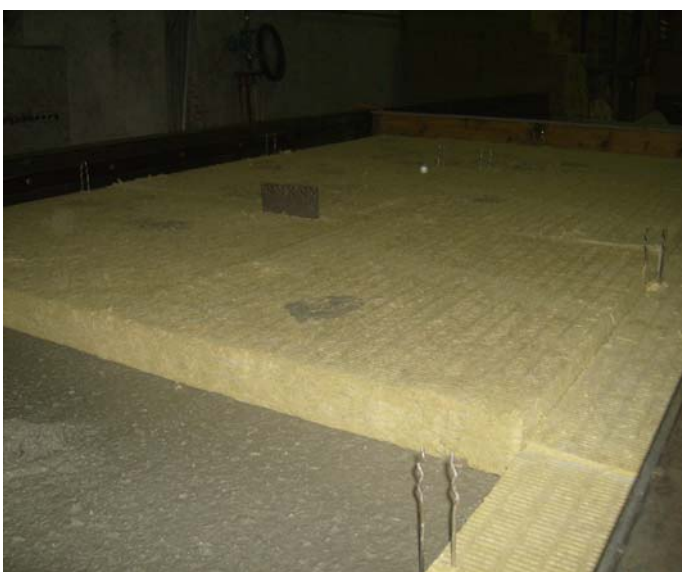
Slika 15: Razporeditev toplotne izolacije debeline 4 in 8 cm pri fasadnih elementih 26 cm.
