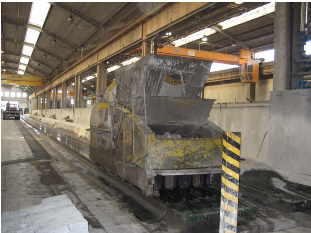
Slika 4: Stroj za betoniranje na stezi prednapetih votlih plošč
