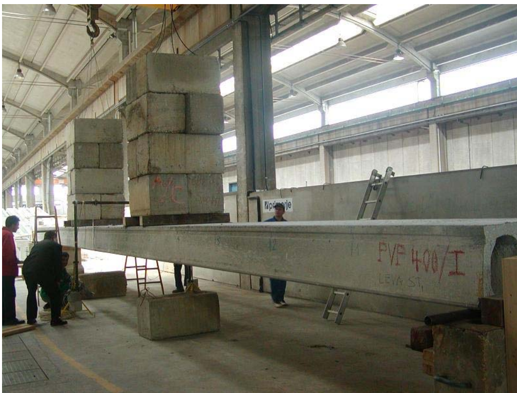
Slika 3: Merjenje pomika prednapetih votlih plošč
