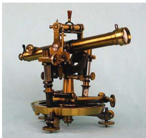
Slika 3: Mehanski teodolit iz leta 1890 ( http://www.geof.hr )
