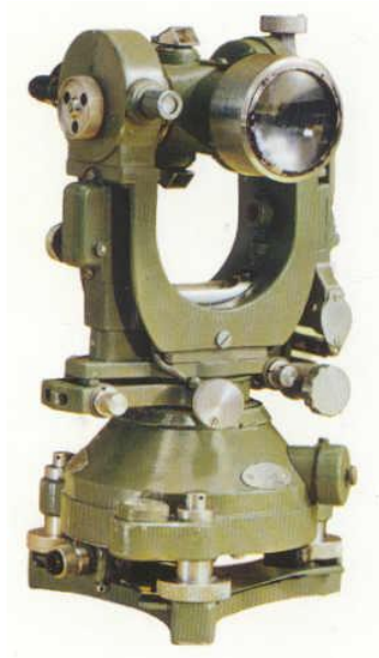
Slika 4: Optično – mehanski teodolit Wild T2, ki je omogočal 1 sekundno odčitavanje (Štular S., 2008, stran 6)
