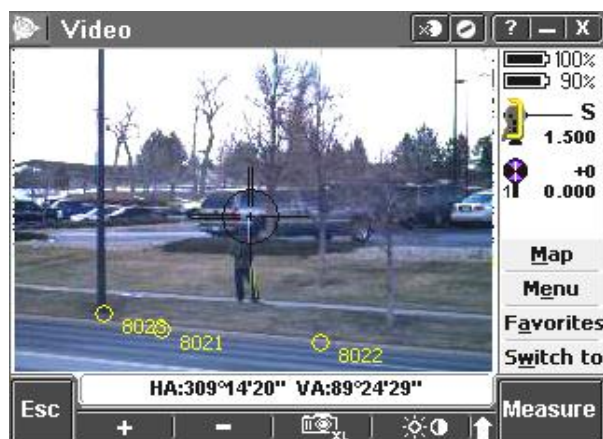
Slika 14: Prikaz funkcije Trimble VISION (video način)
