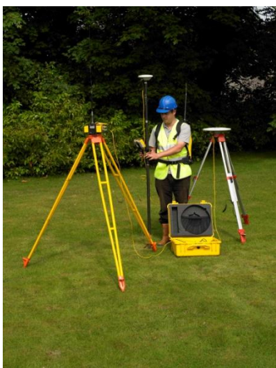
Slika 5: Pomoč GPS tehnologije pri merjenju rečnih profilov
