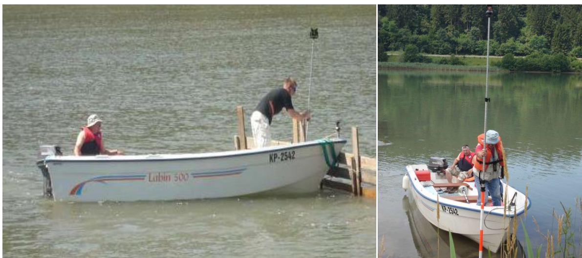
Slika 35: Potek meritev s pomočjo trasirke
