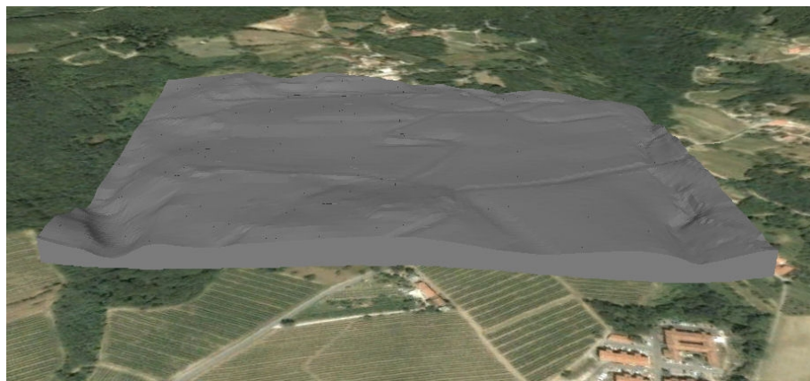
Slika 27: 3D model terena izdelan iz trikotniške mreže.
