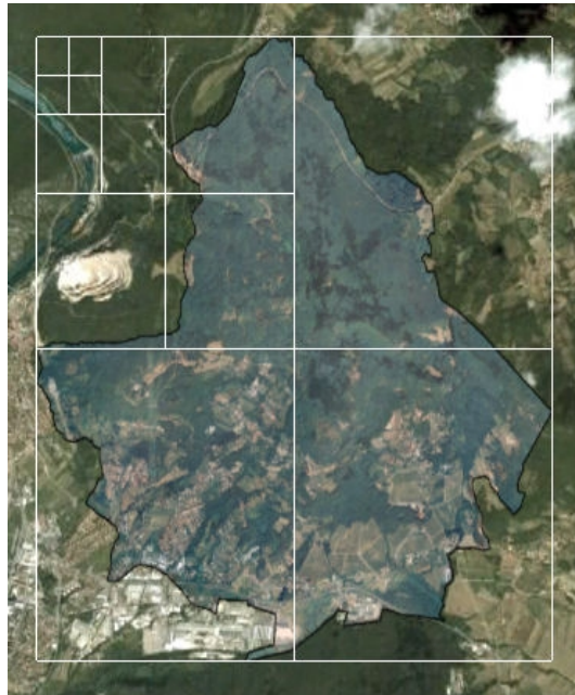
Slika 19: Pravokotniki prikazujejo princip delitve na nivoje in osnovo za razrez podob.
