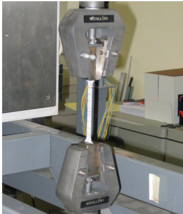
Slika A.2: Natezni preizkušavec (epruveta) vpet v preizkuševalno napravo Figure A.2: Specimen ready for tensile test
