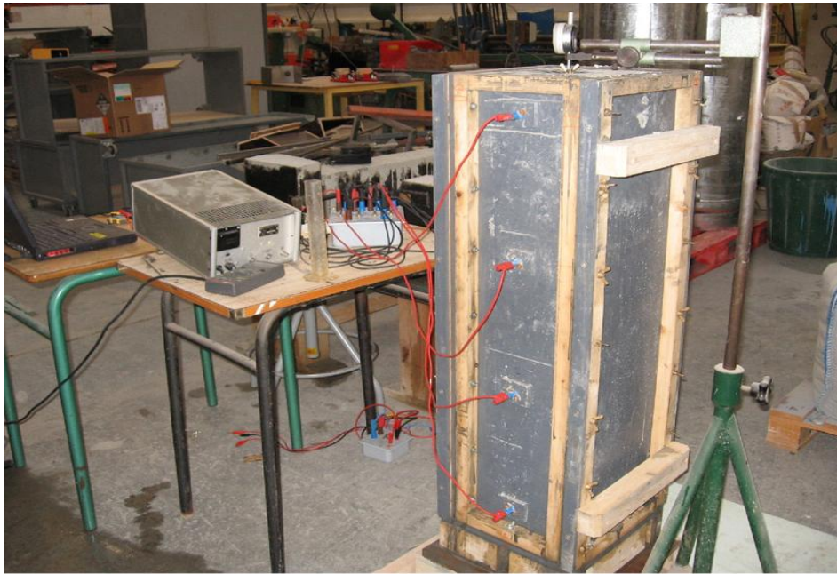
Slika 11: Opaž z vgrajenimi elektrodam (Vir: Khayat)
