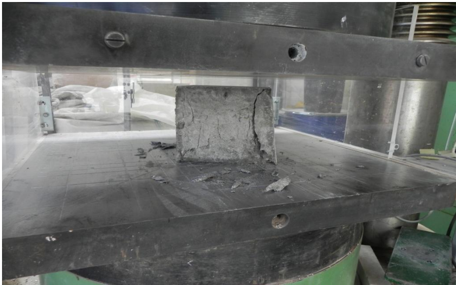
Slika 10: Določanje tlačne trdnosti betona v preši do porušitve
