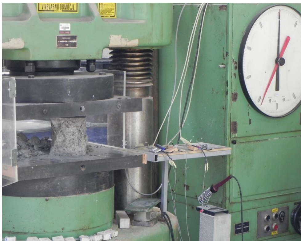
Slika 27: Preiskovanje tlačne trdnosti betona v preši - porušitev
