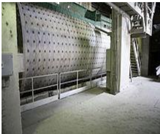
Slika 2: Mletje klinkerja (Vir: http://sl.wikipedia.org/wiki/Cement )
