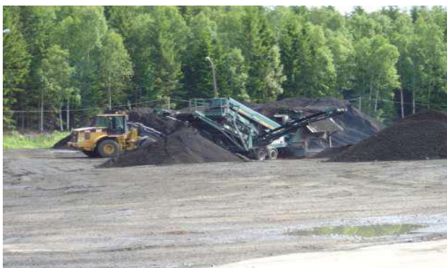
Slika 2: Dozorel, stabiliziran, zdrobljen in presejan odpadni lesni pepel v kupih (Ribbing, 2010)
