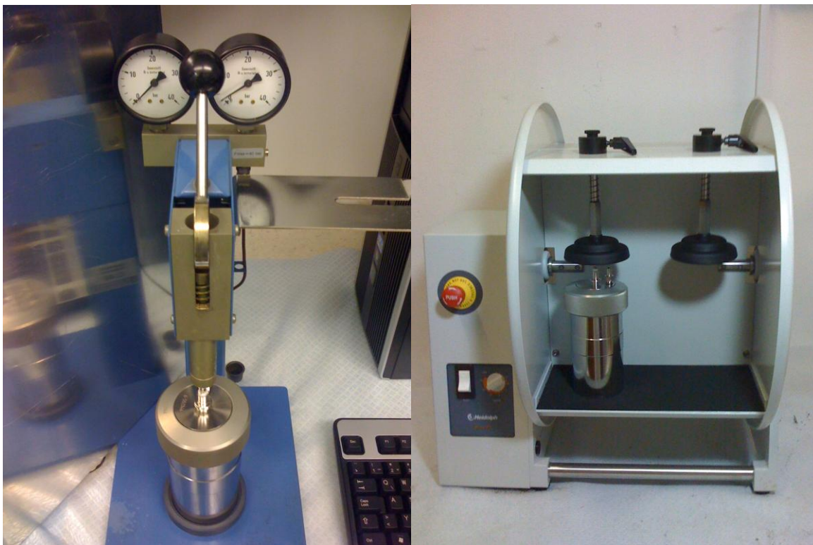
Slika 6: Kalorimetrijska bomba s pepelom in CO 2 (levo) in polnilna naprava z manometrom (desno)
