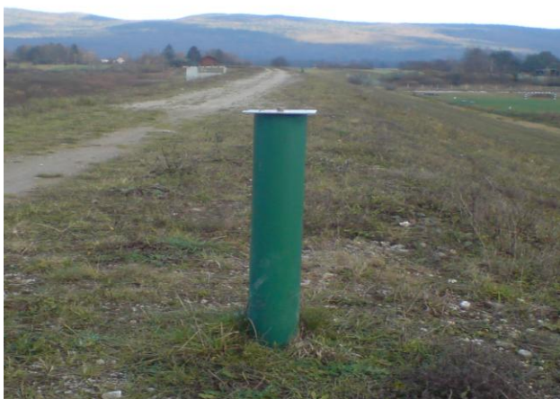
Slika 7: Kontrolna točka, nanj pritrdimo prizmo s podnožjem, ter postavimo nivelmansko lato
