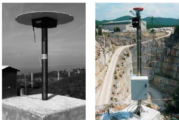
Slika 2: Prisilno centriranje GNSS antene na referenčni/kontrolni točki (Savšek et al., 2010 in Rošer, 2009).
