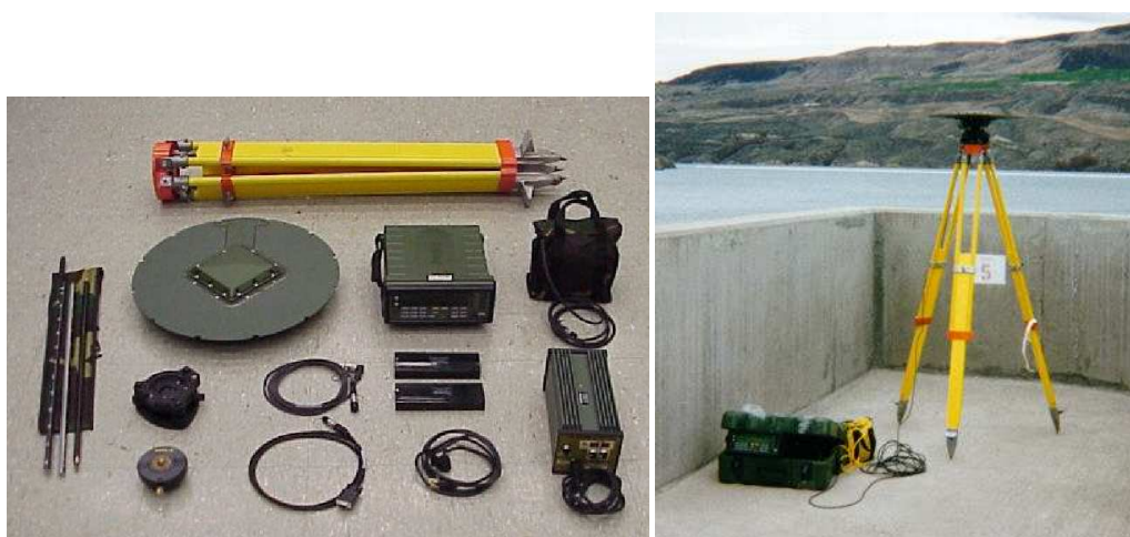
Slika 8: Oprema za statični način GNSS določitve položaja (US Army Corps of Engineers, 2002).
